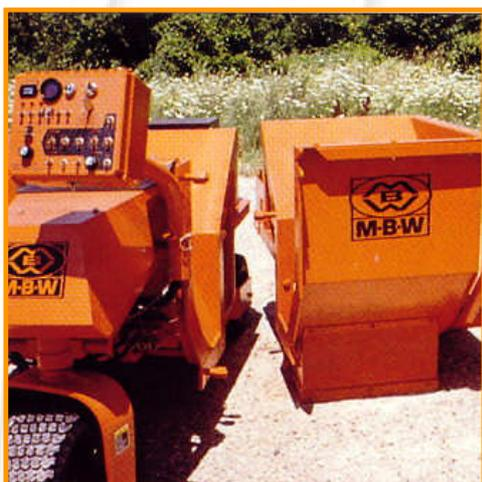
Le système de trémie à attache rapide de **MBW** permet aux utilisateurs de passer du système de coulée latéral (bordures de trottoirs) au système de coulée sous la machine (grosses bordures, caniveaux, etc...) en quelques minutes.
